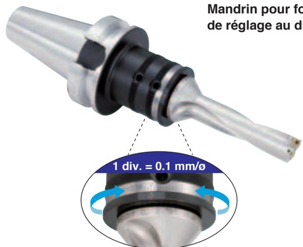
Le diamètre de perçage est réglable en faisant tourner la douille excentrique.
